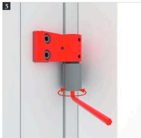
**4** Um den Flügel horizontal zu verstellen, lösen Sie die beiden markierten Schrauben. Verwenden Sie den Inbusschlüssel 4.
